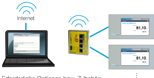
TCP/IP-Verbindung (VPN per UMTS/3G-Router)
